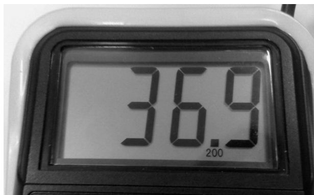
Fig.9 - Tensão DC medida na saída do quadruplicador de tensão sem carga.
